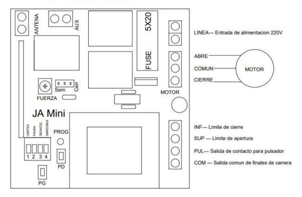
IMPORTANTE: El capacitor se conecta en los cables de apertura y cierre del motor.
